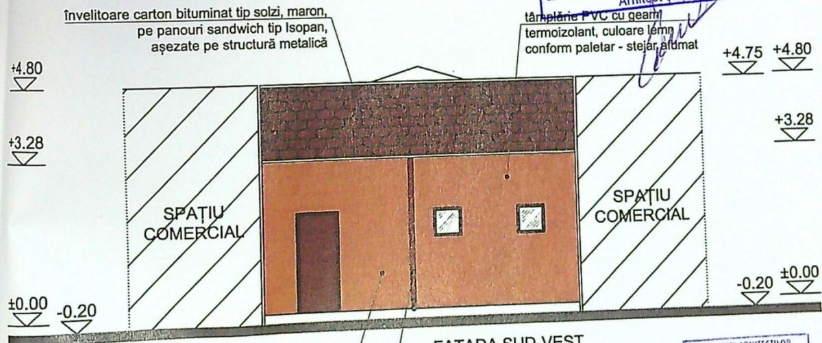
învelitoare carton bituminat tip solzi, maron, pe panouri sandwich tip Isopan, așezate pe structură metalică
